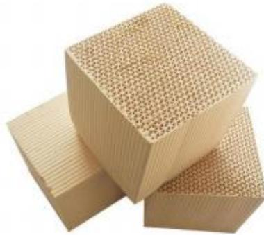
蜂窝沸石，由不同孔径的疏水性沸石组合分为两种：挤压式和涂覆式，孔径率 60%左右，比表面积 500-1000m<sup>2</sup>/g。沸石蜂窝结构，具有非常优异的有机废气吸附性能和良好的气体通过性，特别适合于大风量、低浓度 vocs 气体处理。
