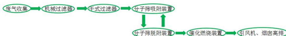
图 3-1 有机废气处理工艺流程图
